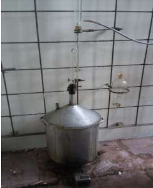
Rangkaian alat destilasi uap dan air
