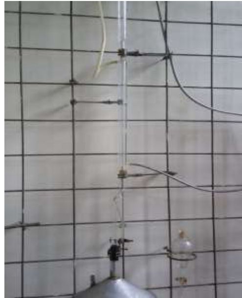
Rangkaian alat destilasi uap dan air
