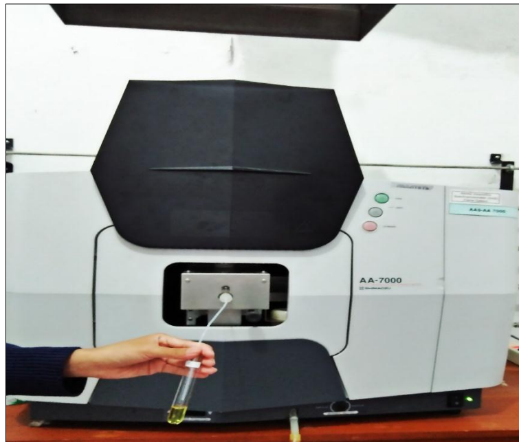
Pembacaan Sampel menggunakan SSA
