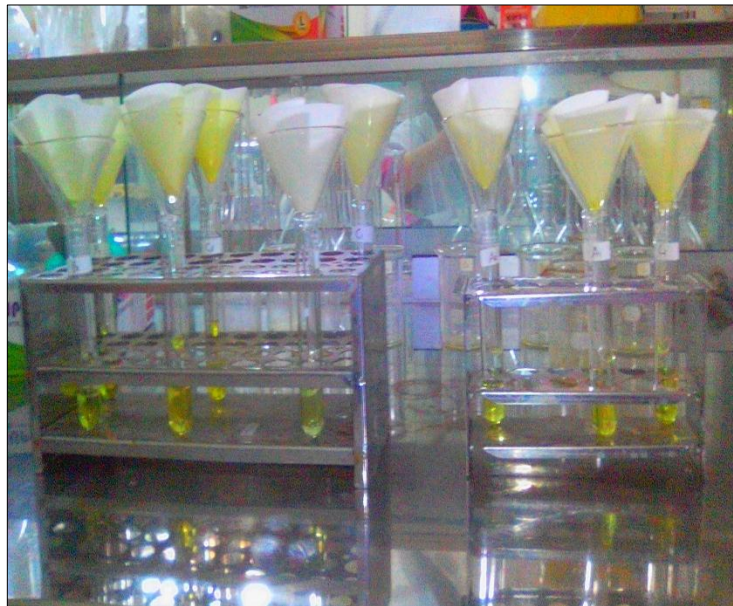
Penyaringan sampel menggunakan kertas Whatman 42
