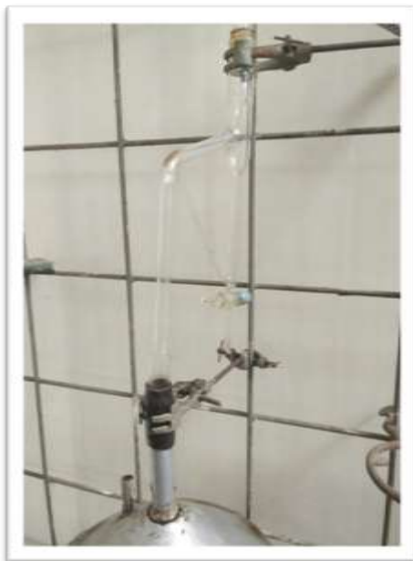
Rangkaian destilasi uap dan air
