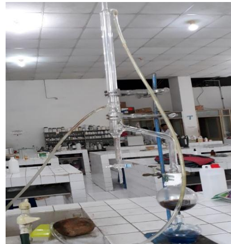
Penetapan kadar air dengan rangkaian alat Sterling-Bidwell
