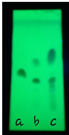
Gambar 12. Hasil KLT nifedipin murni (a), paparan sinar matahari selama 15 menit (b) dan paparan sinar matahari selama 2 hari (c)
