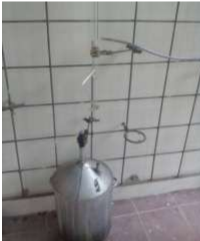
Rangkaian alat destilasi uap dan air
