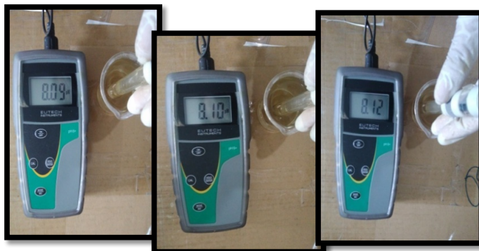
Penetapan Nilai pH padaproses Perendaman oleh Arang Aktif variasi 2 jam
