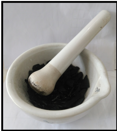
Penggilingan Arang Aktif menggunakan Mortir
