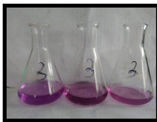
Penetapan Kadar Kesadahan sebelum proses Perendaman oleh Arang Aktif
