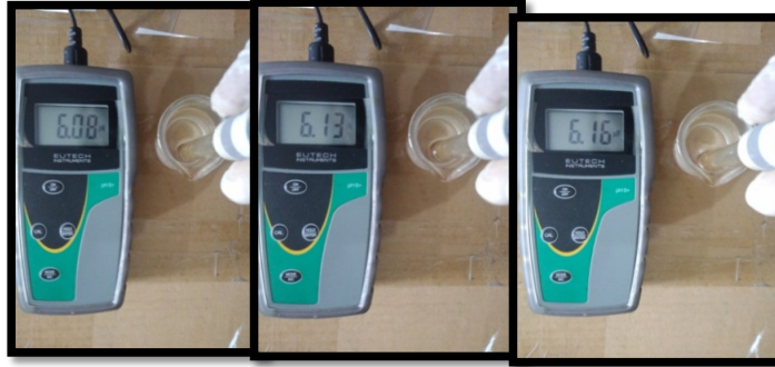
Penetapan Nilai pH pada proses Perendaman oleh Arang Aktif variasi 4 jam
