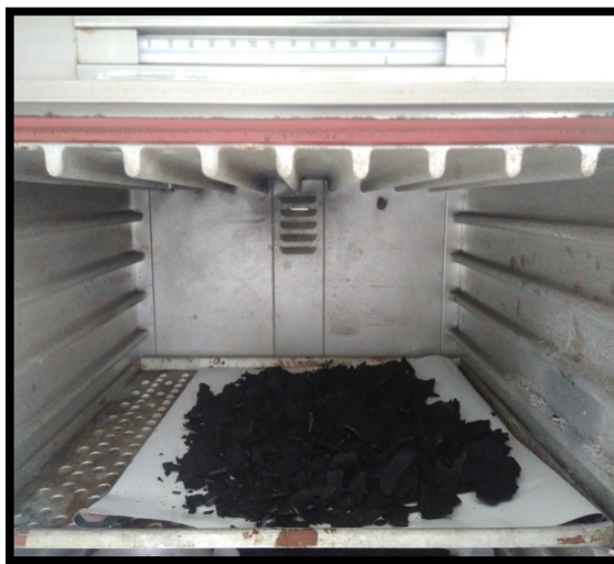
Hasil Arang yang diaktifasi dan dikeringkan pada Furnace
