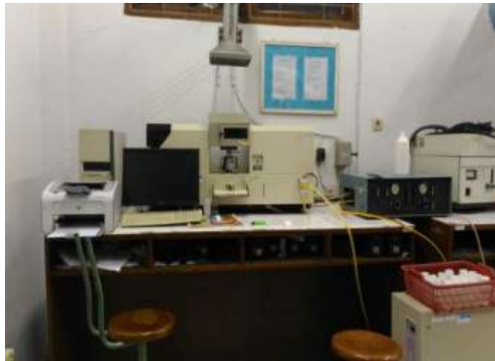
Foto alat Spektrofotometer Serapan Atom AA 6650 F Shimadzu
