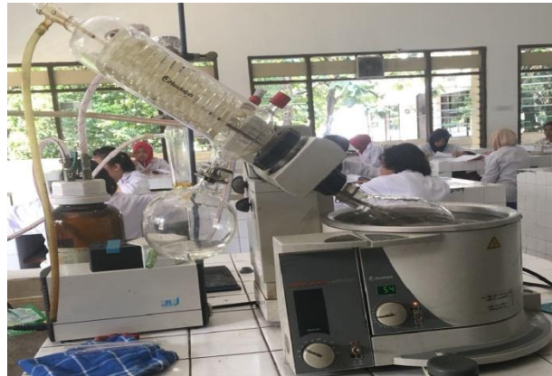
Pembuatan ekstrak dengan alat rotary evaporator
