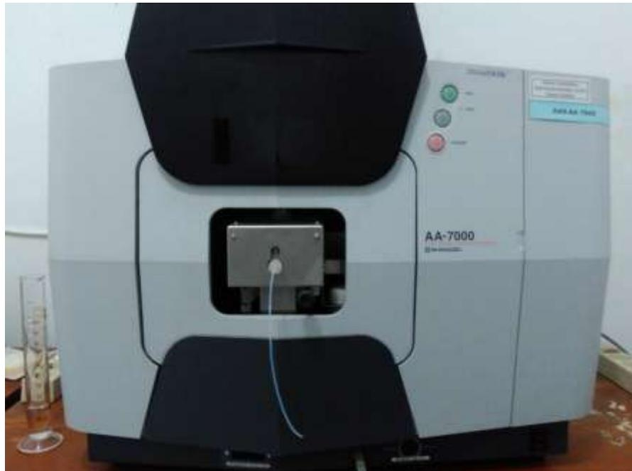
Gambar 6. Spektrofotometri Serapan Atom AA-7000
