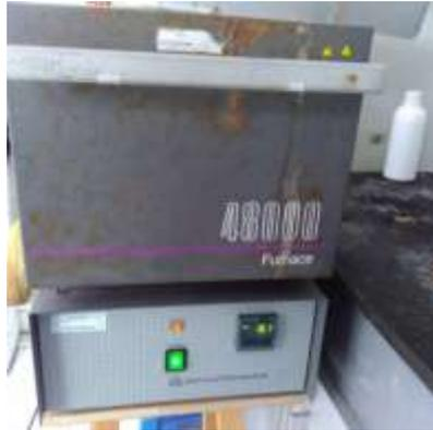
Gambar 9. Muffle Furnace untuk pengabuan Sampel
