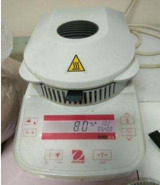
Gambar 1. Uji Kadar Air dengan Moisture Balance
