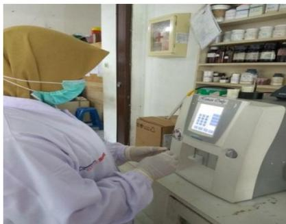
**Gambar 4. Alat hematologi analyzer**
