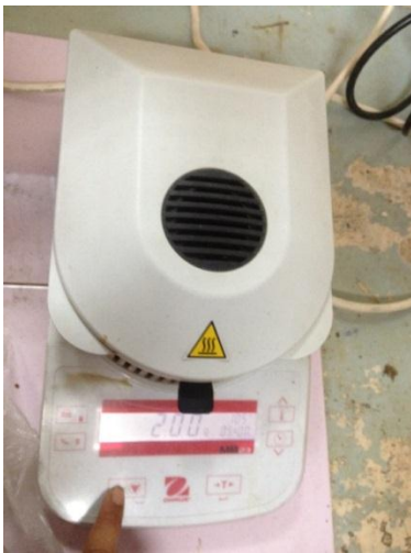
Gambar 5. Foto alat moisture balance
