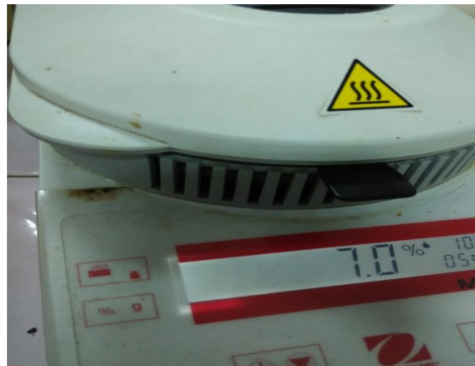
Moisture balance (alat untuk menghitung kadar air)
