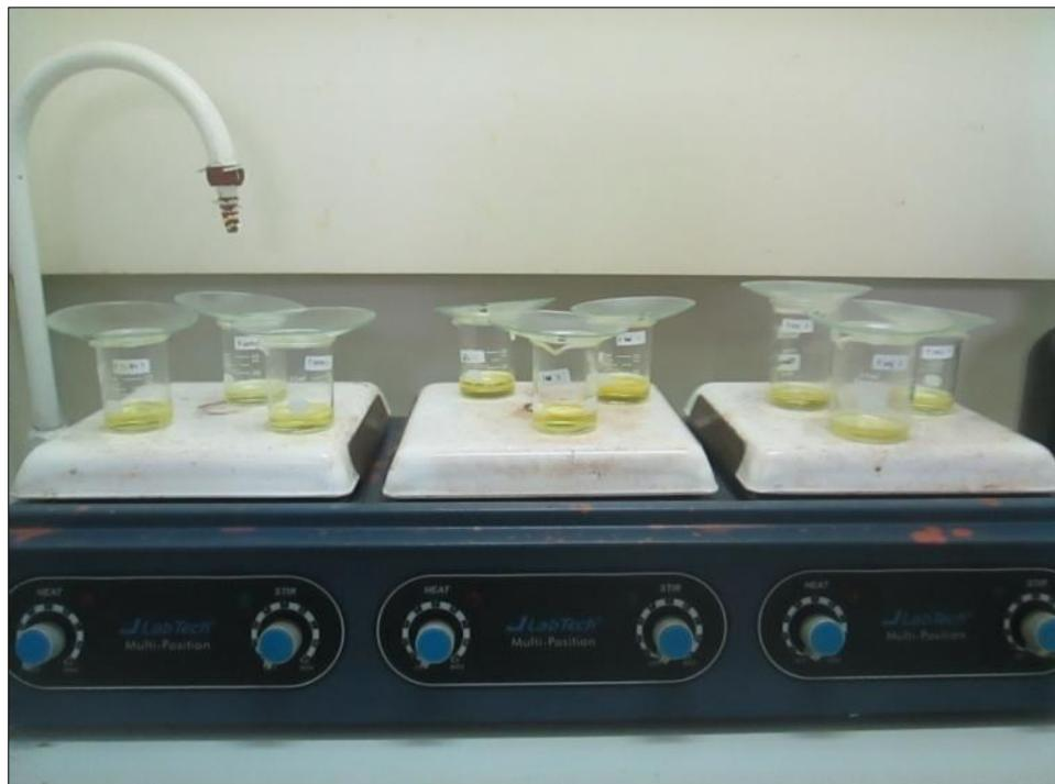
Proses destruksi basah dengan larutan  $\text{HNO}_3$
