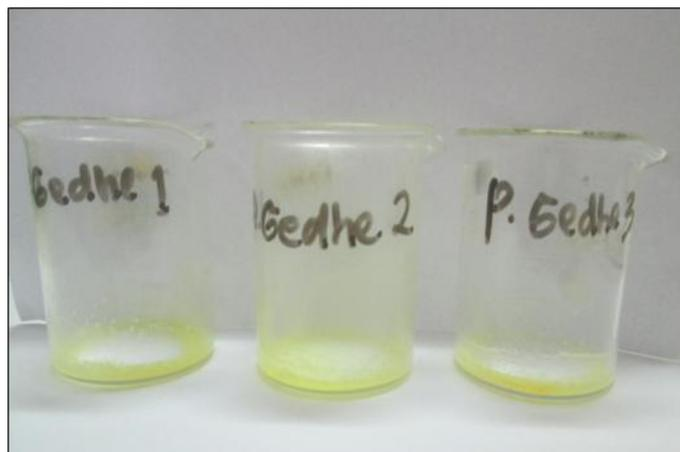
Hasil destruksi dengan  $\text{HNO}_3$  pada sampel Pasar C
