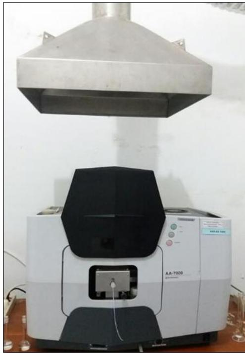
Alat Spektrofotometri Serapan Atom dan Ducting
