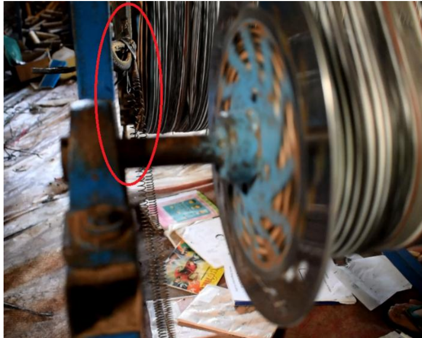
Gambar 17. Kondisi awal sistem pengereman
