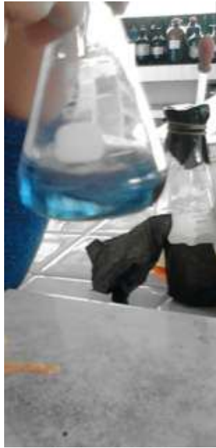
Gambar 12. Standarisasi larutan \text{Na}_2\text{S}_2\text{O}_3 dengan larutan \text{KIO}_3
