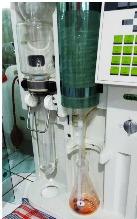
Memasang labu kjeldahl dan erlenmeyer pada alat destilasi
