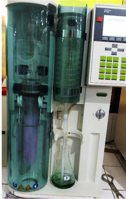
Larutan didalam erlenmeyer berubah menjadi hijau menandakan ada kandungan nitrogen
