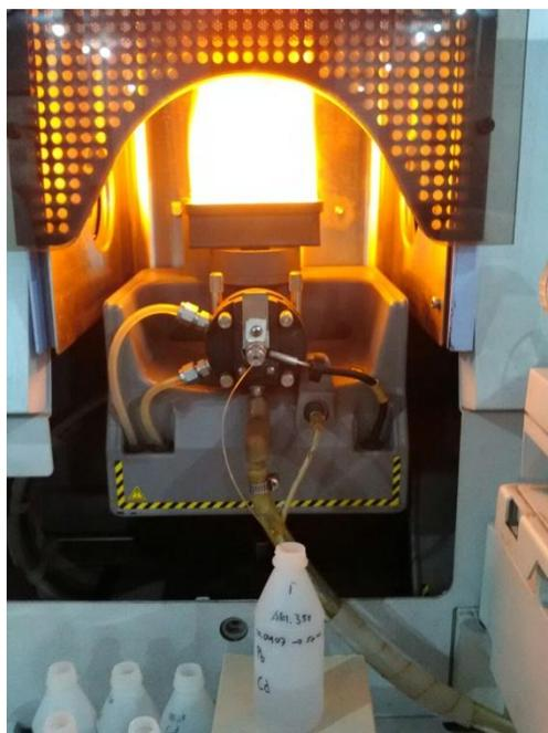
**Gambar 6.6** Analisis Sampel dengan SSA
