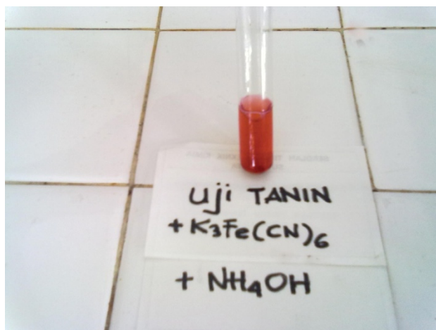
Hasil uji infus kulit buah manggis ditambah K 3 Fe(CN) 6 kemudian ditambah NH 4 OH
