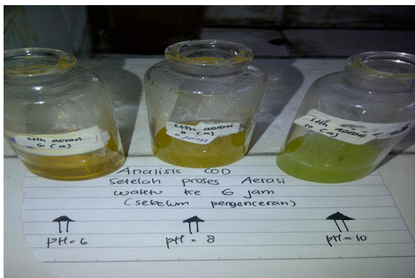
Gb 7. Uji COD setelah proses Aerasi lumpur aktif sebelum pengenceran dan sesudah pengenceran
