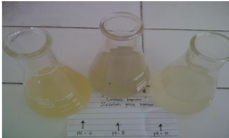
Gb 6. Uji COD setelah proses klorinasi sebelum pengenceran dan sesudah pengenceran
