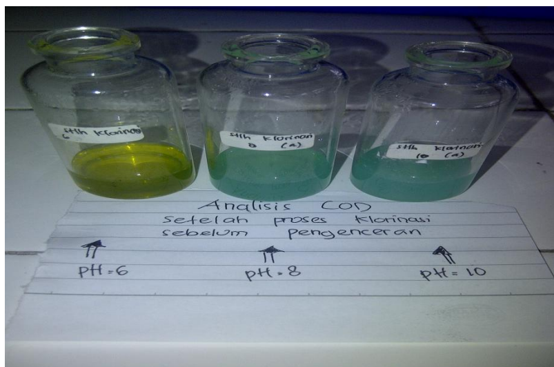
Gb 6. Uji COD setelah proses klorinasi sebelum pengenceran dan sesudah pengenceran
