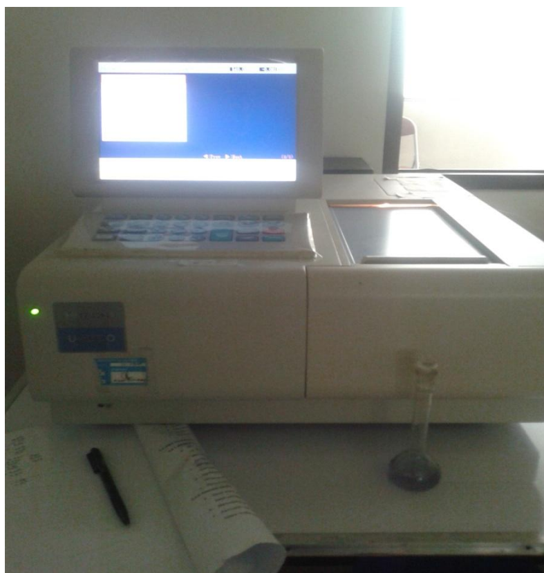
Gambar 26. Menganalisa krom limbah dengan Spektrofotometri Uv-Vis
