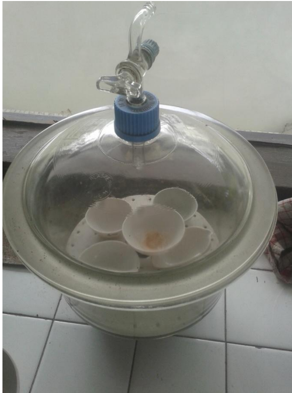
Gambar 17. Cawan porselin dalam desikator proses pengkonstanan alat
