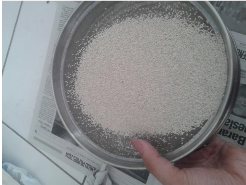
Gambar 15. zeolit yang digunakan dengan ukuran saringan kasa 18-40 mesh
