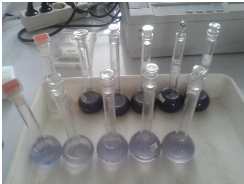
Gambar 25. Persiapan sampel limbah batik yang sudah diaktivasi untuk dianalisa dengan Spektrofotometri Uv-Vis
