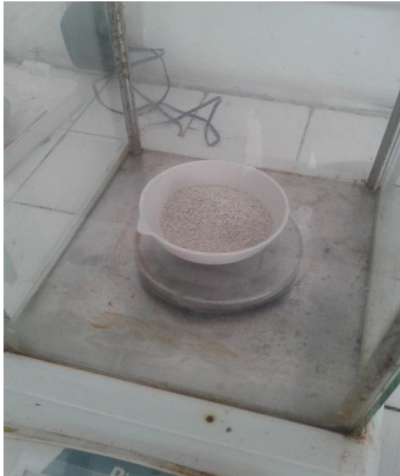
Gambar 18. Menimbang zeolit pada neraca analitik
