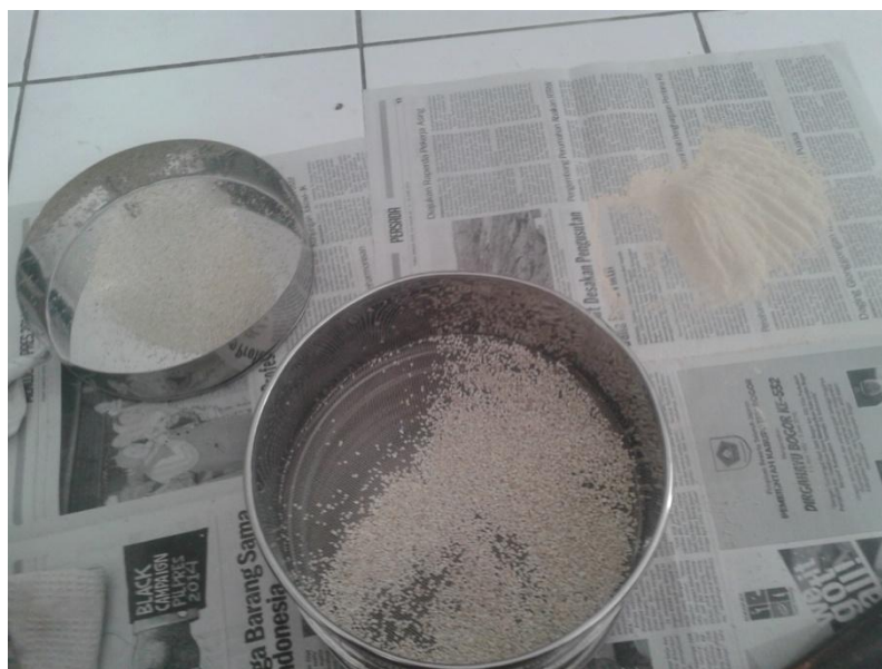
Gambar 14. Mengayak zeolit dengan saringan kasa 18-40 mesh
