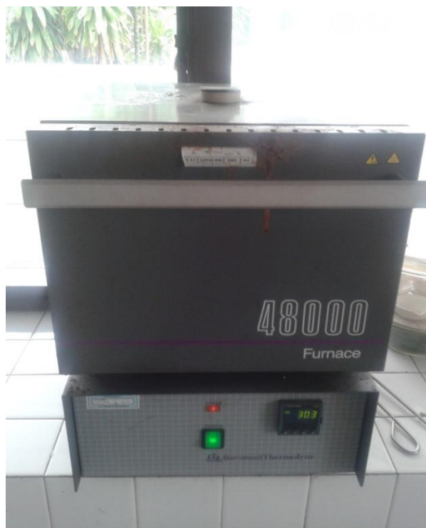
Gambar 19. Pemanasan zeolit pada muffle sesuai variabel yang ditentukan
