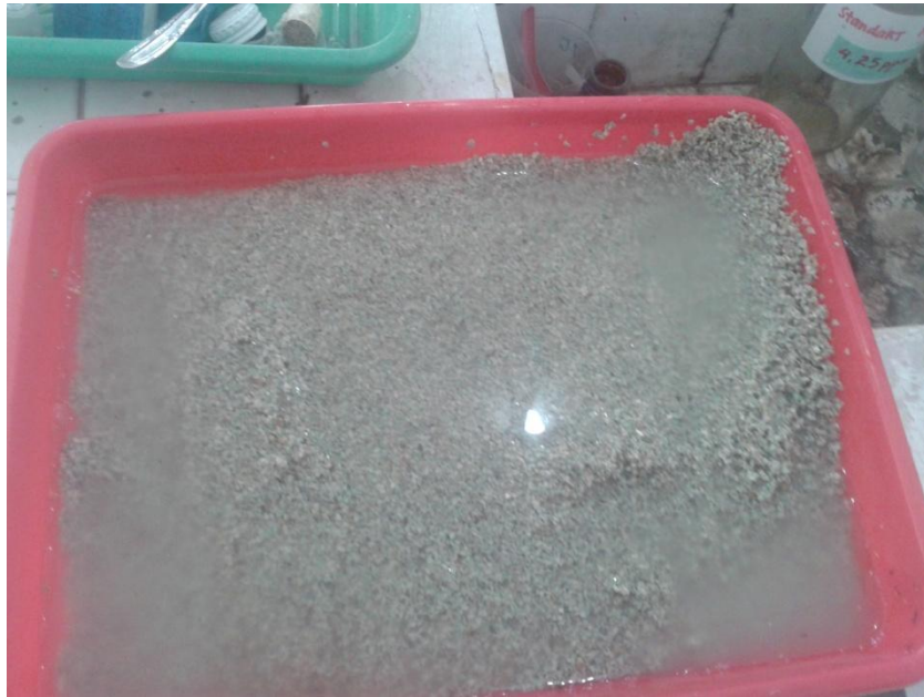
Gambar 11. Tahap kedua pencucian zeolit dengan aquadest
