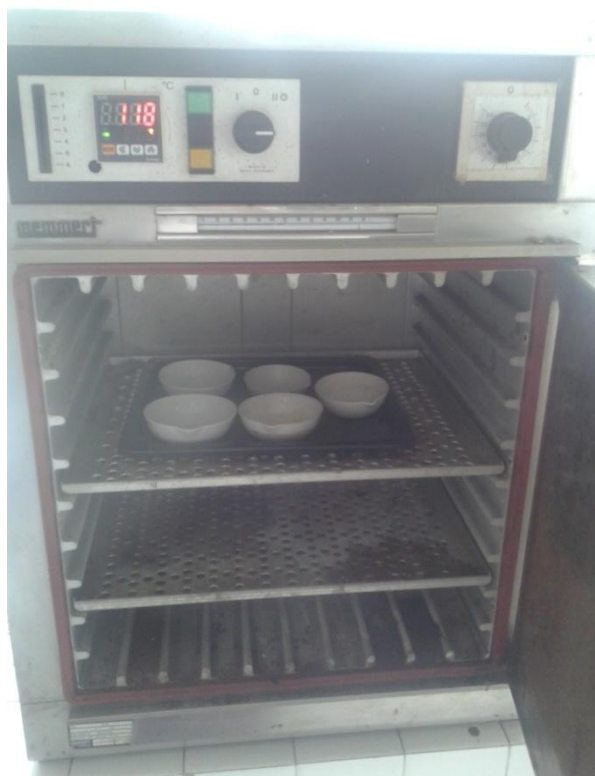
Gambar 16. Pengkonstanan alat Cawan porselin
