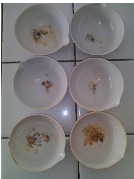
Gambar 6.7 Cawan + kertas saring + residu setelah difurnace pada suhu 550^{\circ} C 15 menit.
