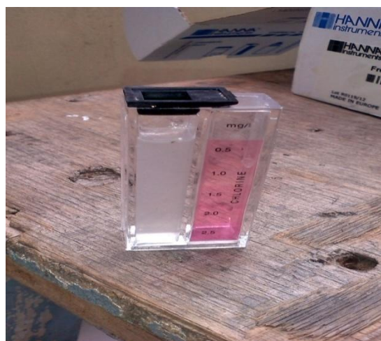
Gambar 6.2 Pengukuran kandungan klor bebas dengan menggunakan alat Comparator Chlor
