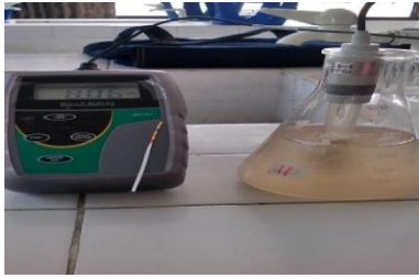
Gambar 6.3 Pengukuran pH dengan menggunakan pH meter
