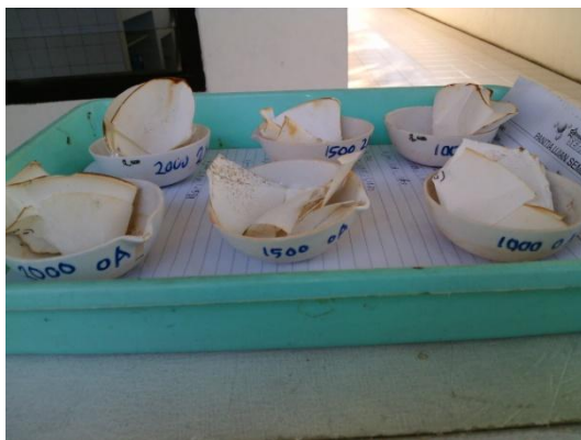
Gambar 6.6 Cawan + kertas saring + residu setelah dioven pada suhu 105^{\circ} C 1 jam.
