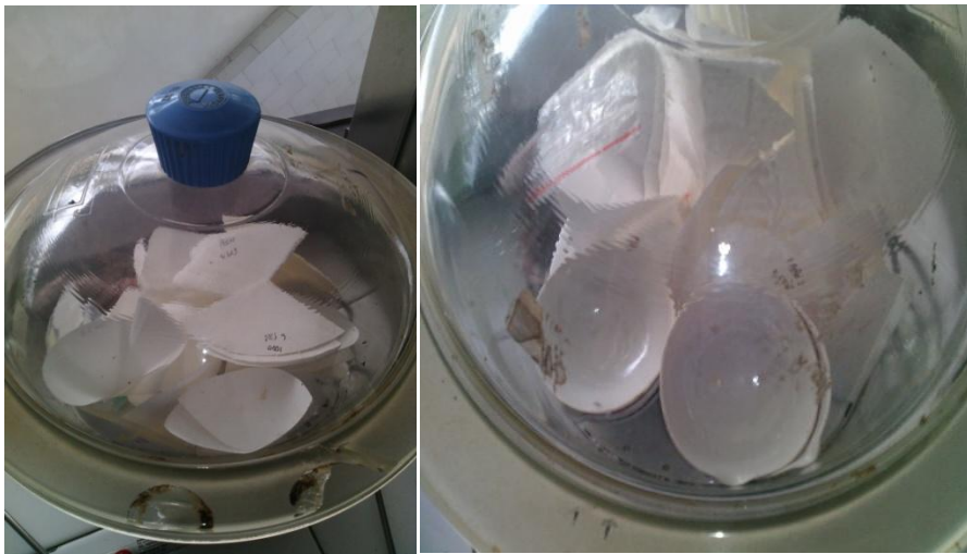
Gambar 6.4 Kertas saring dan cawan yang telah dikonstankan di oven pada suhu 105 0 C 1 jam.
