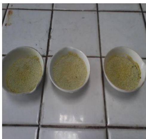
Gambar 4. Hasil zeolit setelah diaktivasi.
