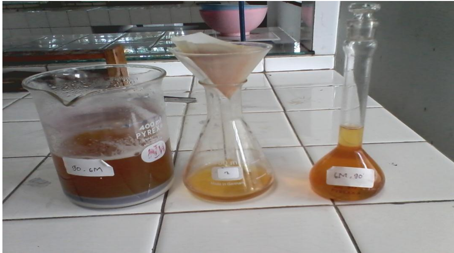
Gambar 9. Campuran yang didamkan selama 24 jam kemudian disaring dan siap dianalisis.
