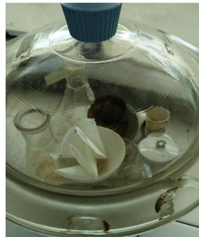
**Gambar 6.5** Mengoven dan memasukkan dalam desikator
