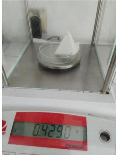
**Gambar 6.6** Menimbang kertas saring yang digunakan uji TSS
