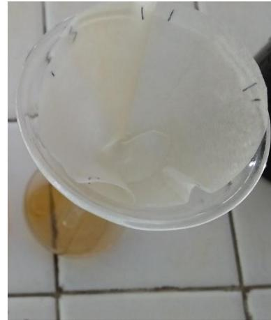
**Gambar 6.4** Menimbang dan menyaring sampel pada uji TSS
