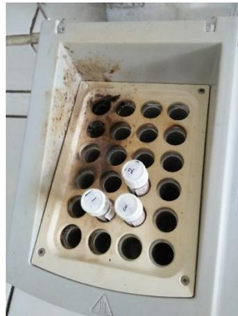
**Gambar 6.7** Sampel setelah ditambah reagen dan direfluks selama 2 jam
