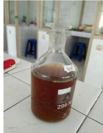
**Gambar 6.12** Sampel diambil 100 ml dan sisanya ditambah  $\text{H}_2\text{SO}_4$  p
