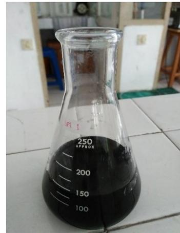
**Gambar 6.13** Melakukan titrasi sampel hingga kuning muda dan menambah amilum
