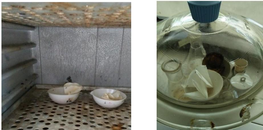
**Gambar 6.3** Pengovenan kertas saring dan memasukkan dalam desikator
