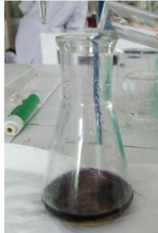
**Gambar 6.9** Standarisasi larutan  $\text{Na}_2\text{S}_2\text{O}_3$  dan penambahan amilum
