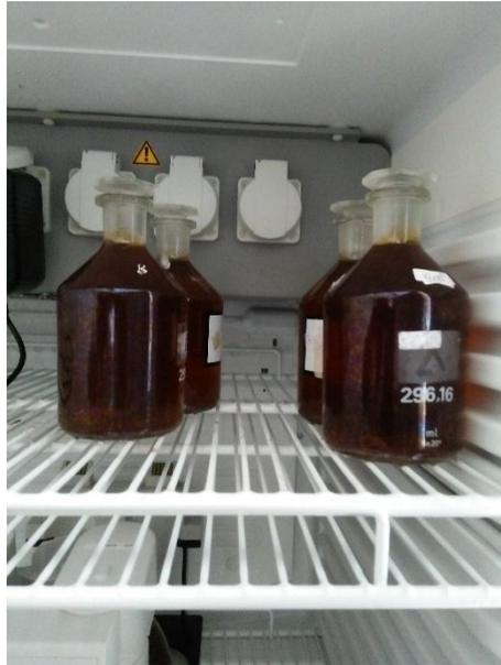
**Gambar 6.15** Inkubasi sampel pada uji BOD<sub>5</sub>
