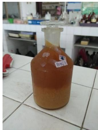
**Gambar 6.11** Pengenceran sampel dan melakukan analisis BOD
