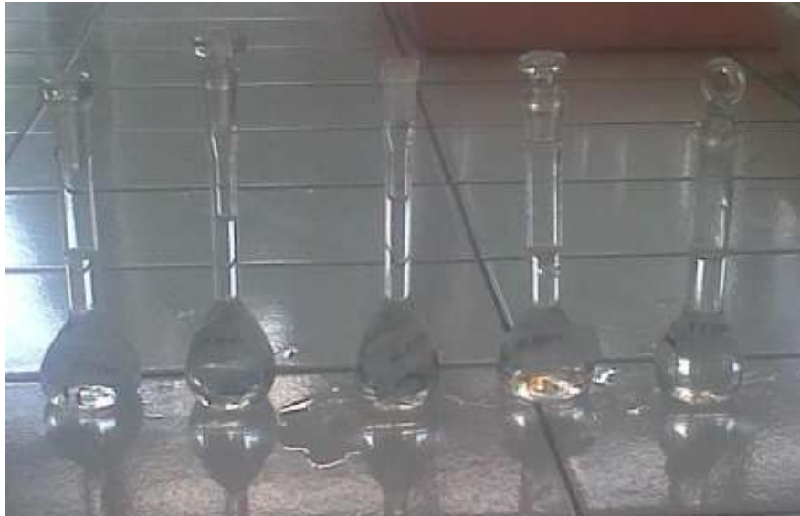
Gambar pembuatan kurva kalibrasi konsentrasi 10-50ppm
