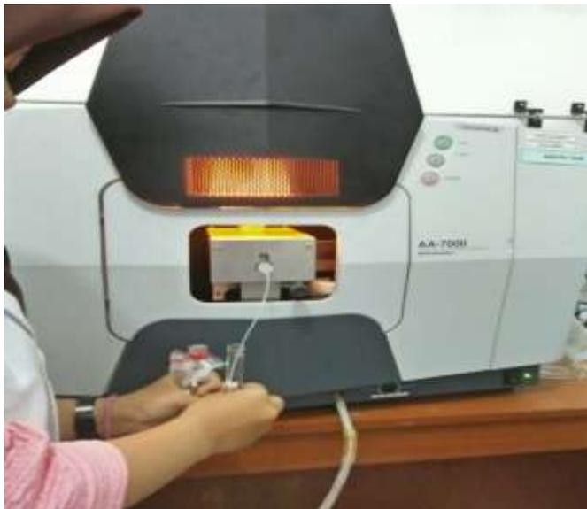
**Gambar 2. Alat Spektrofotometri Serapan Atom**
