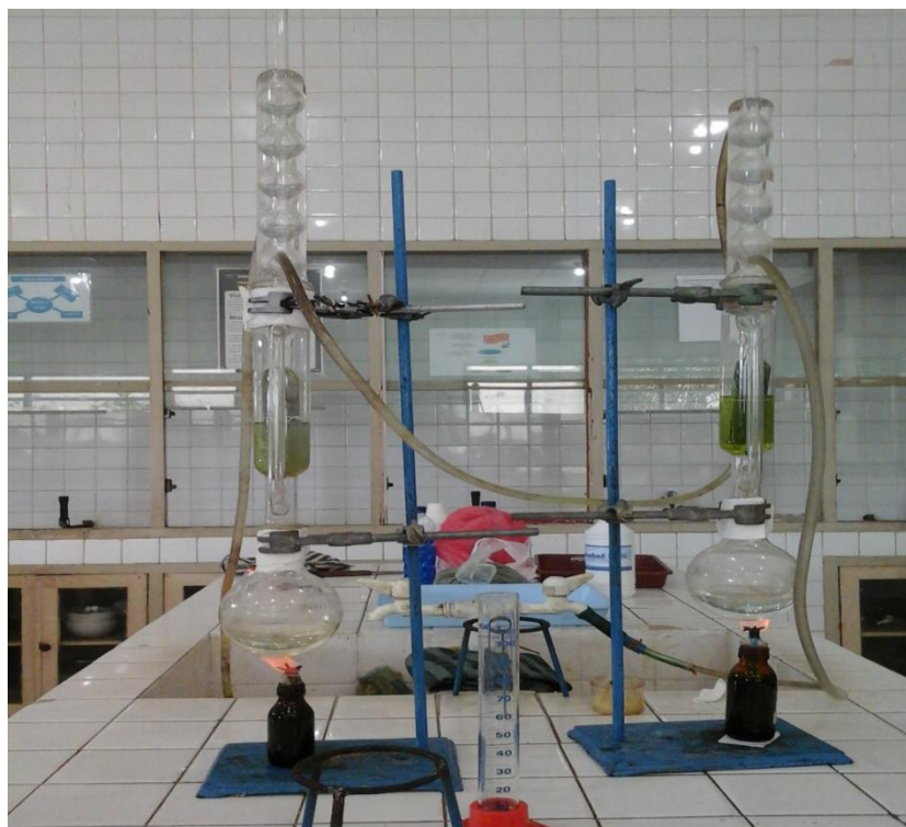
Lampiran 13. Rangkaian alat soxhlet untuk pembuatan ekstrak
