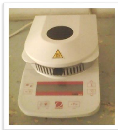
Foto 2. Alat Moisture Balance
