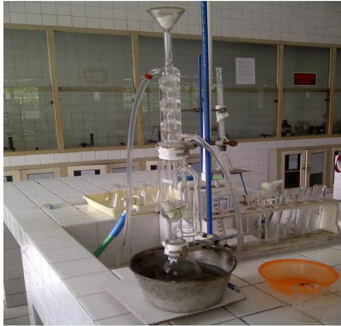
Gambar 13. Rangkaian Alat Pendingin Tegak
