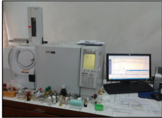
Kromatografi gas dengan spectrometer massa Shimadzu QP-500
