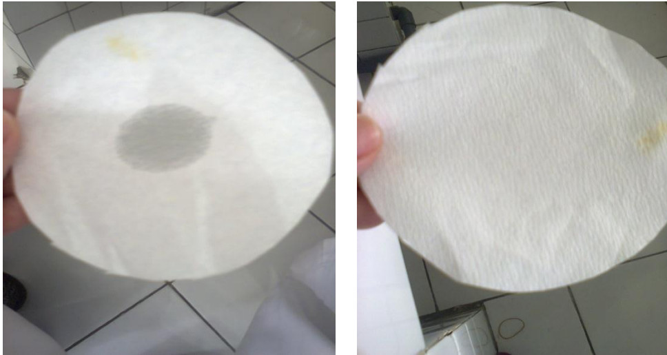
Gambar 17. Foto hasil uji identifikasi minyak atsiri kulit batang kayu manis dengan kertas saring
