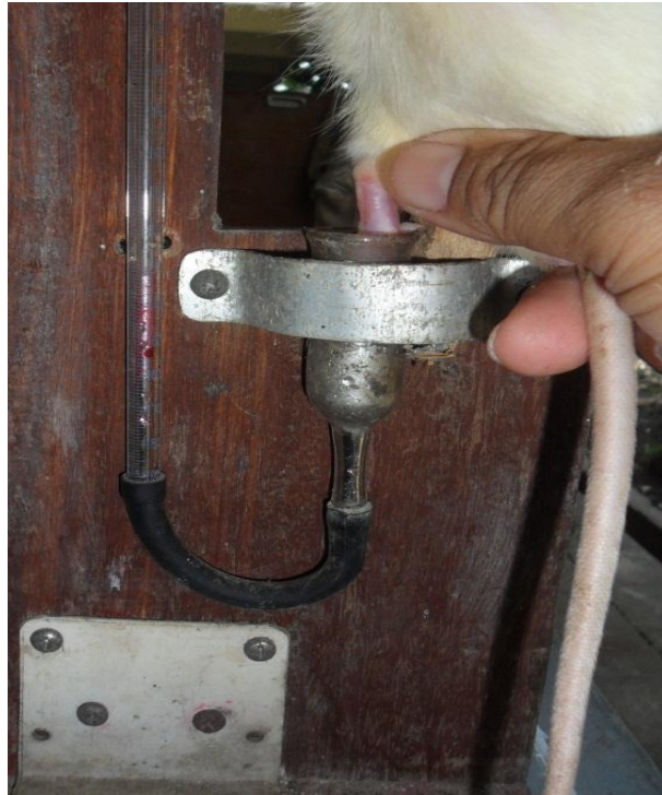
Foto 14. Pengukuran volume uedema dengan alat Pletismometer air raksa
