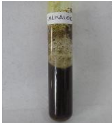
Foto Hasil Identifikasi Alkaloid Daun Sendok. Hasil Positif Terbentuk Endapan Warna Coklat Sampai Hitam.
