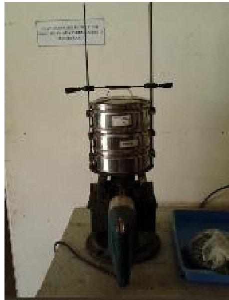
Mesin pengayak dengan ayakan mesh 40
