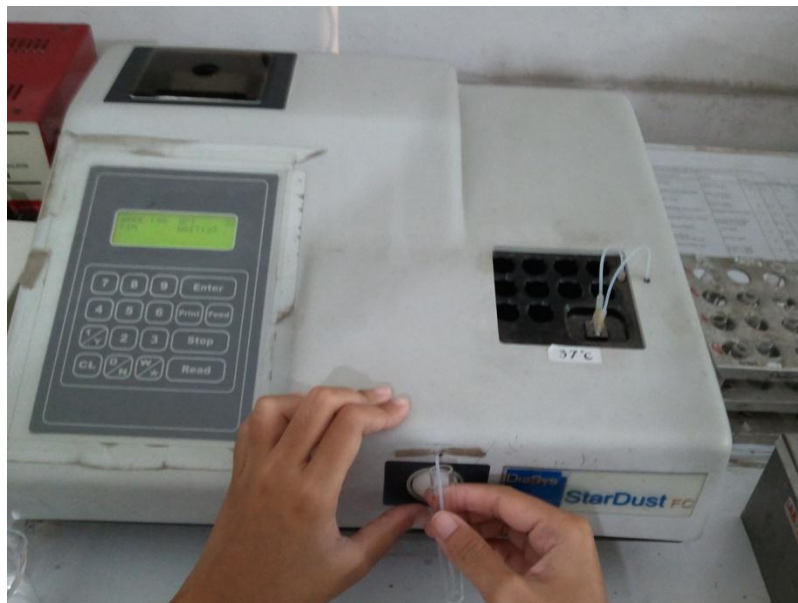
Gambar 17. Foto alat fotometer Stardust FC untuk membaca kadar kreatinin
