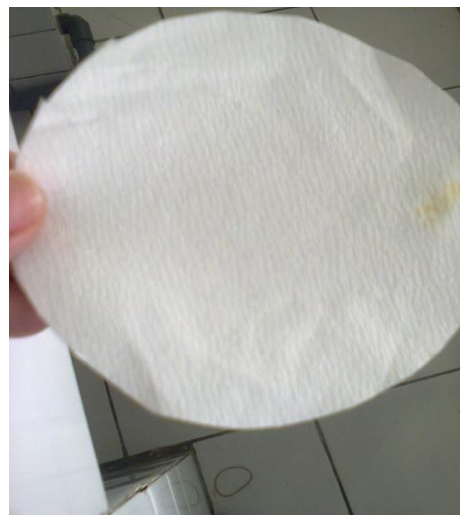
Gambar 8. Foto hasil uji identifikasi minyak atsiri kulit batang kayu manis dengan kertas saring
