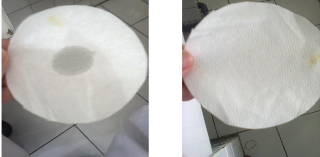
Hasil uji identifikasi minyak atsiri kulit batang kayu manis dengan kertas saring
