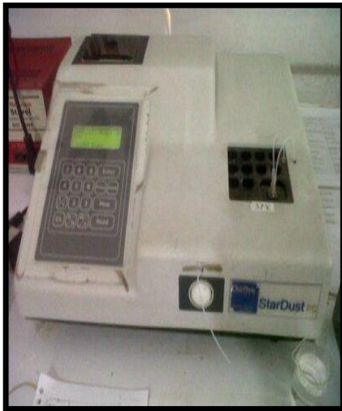
5a. Foto alat fotometer Stardust
