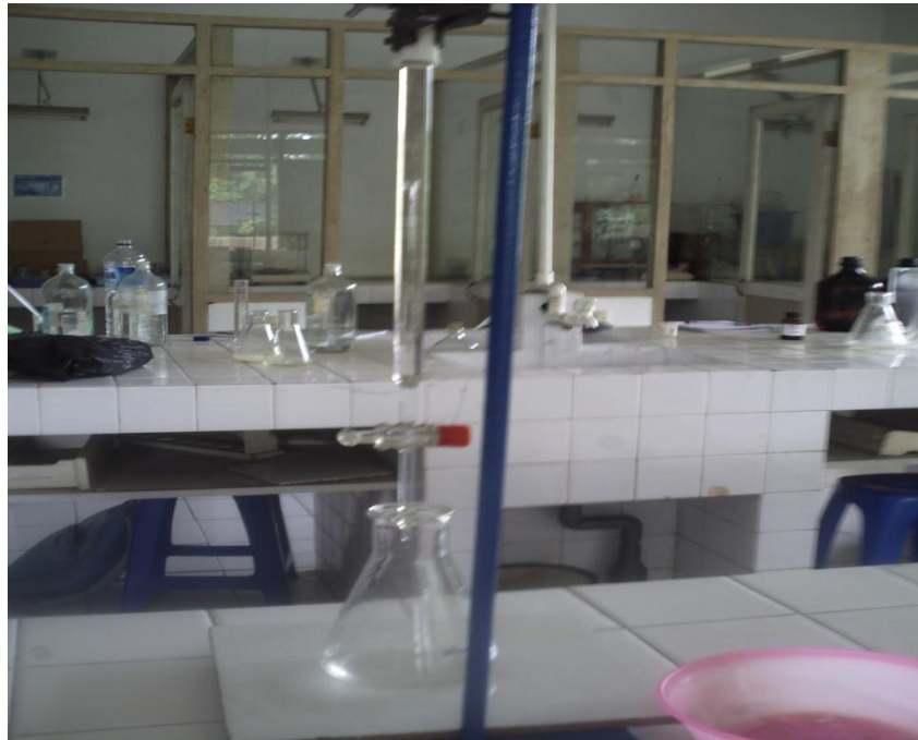
Gambar 3: Hasil akhir titrasi (warna biru hilang)
