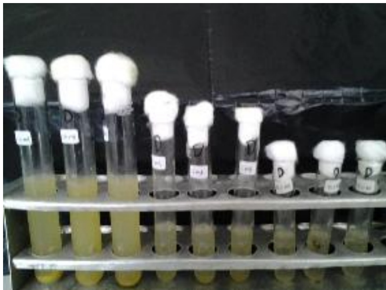
Gambar 12. Hasil pemeriksaan sampel B (Sampel siang) pada media Lactose Broth terdapat 9 tabung positif menunjukkan adanya gas pada tabung Durham (3 tabung besar gas tidak terlihat digama disebabkan karena kekeruhan).
