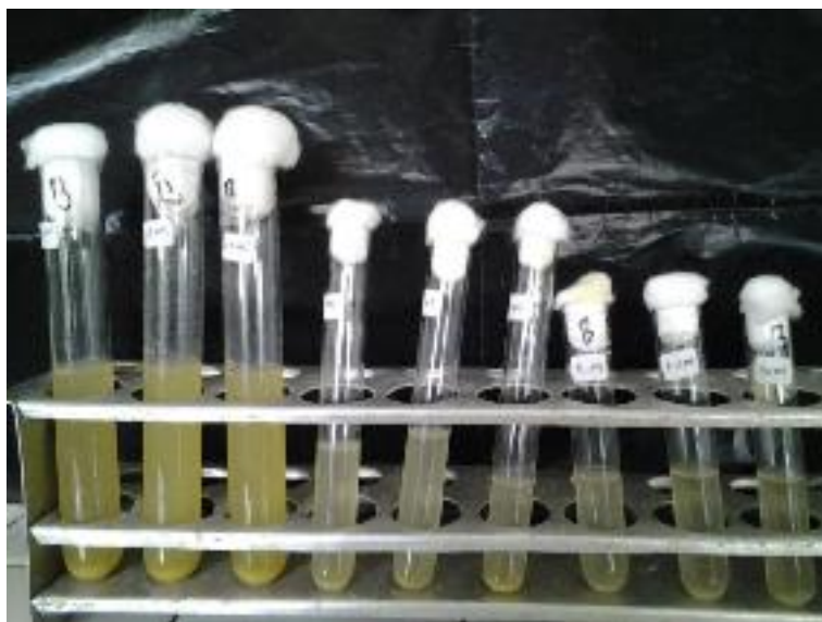
Gambar 10. Hasil pemeriksaan sampel A (Sampel siang) pada media Lactose Broth 9 tabung positif menunjukkan adanya gas pada tabung Durham (3 tabung besar gas tidak terlihat digambar disebabkan karena kekeruhan).
