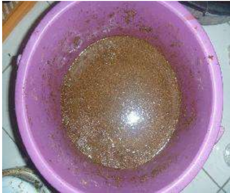
Gambar 8. Media 2 (Pasir, Bata Merah, Serbuk Gergaji dan Seduhan Teh Hijau)
