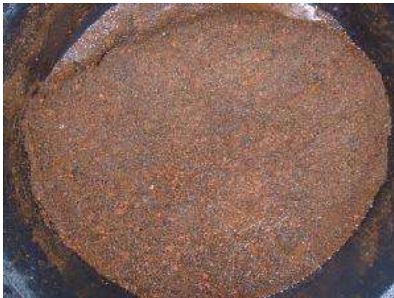
Gambar 7. Media 1 (Pasir, Bata Merah, dan Seduhan Teh Hijau)
