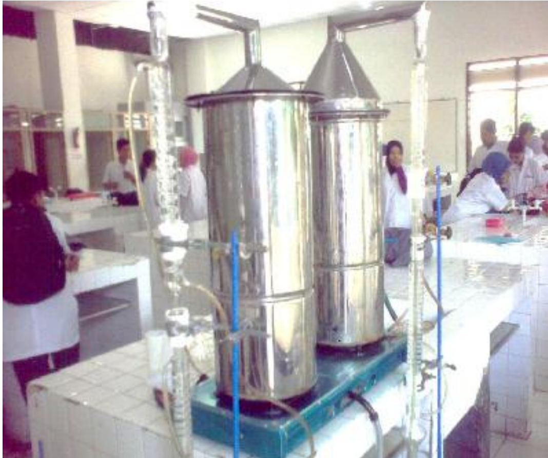
Lampiran 12. Gambar alat destilasi air dan uap
