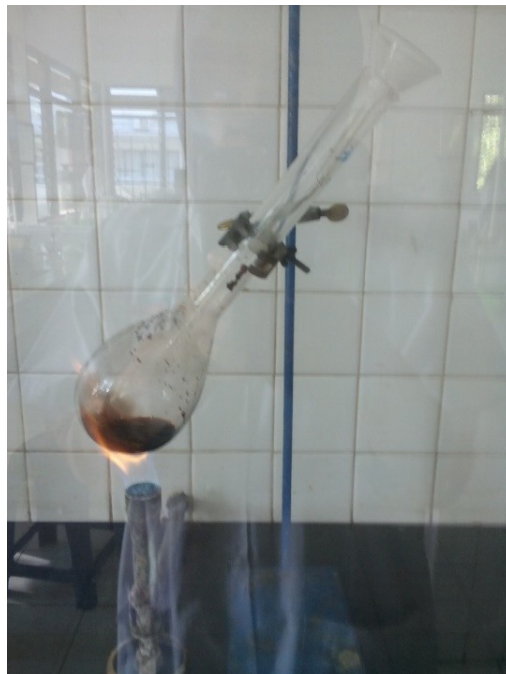
Proses pemanasan labu kjeldhal dalam lemari asam (Proses Destruksi)
