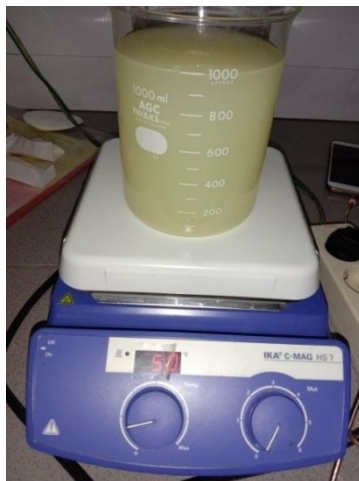
Proses pengolahan limbah cair industri tahu dengan magnetic stirrer
