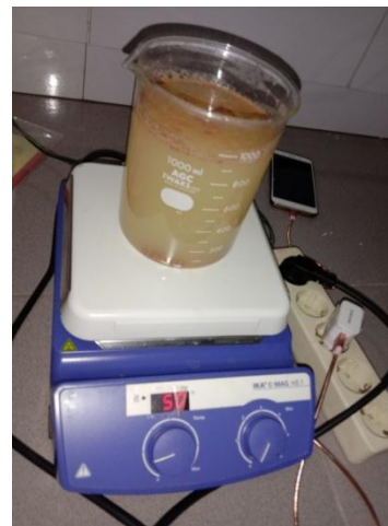
Proses pengolahan limbah cair industri tahu dengan magnetic stirrer
