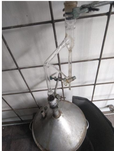
Proses penguapan minyak atsiri
