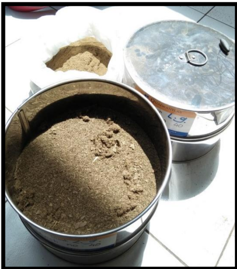
Serbuk kulit buah jeruk kalamansu di ayak dengan ayakan mesh no. 40
