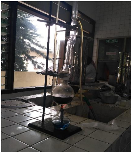
Penentuan kadar air dengan sterlingbidwel
