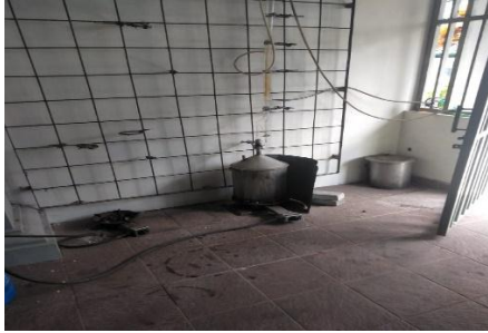
Rangkaian alat destilasi uap dan air
