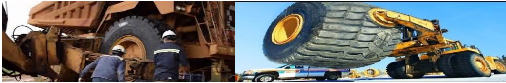
Gambar 1. Proses mengganti ban mobil HD dan tyre handle tools
