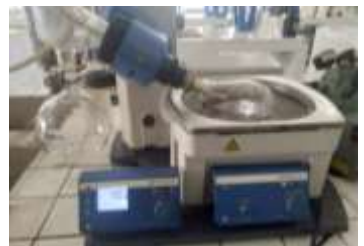
Penguapan etanol menggunakan evaporator
